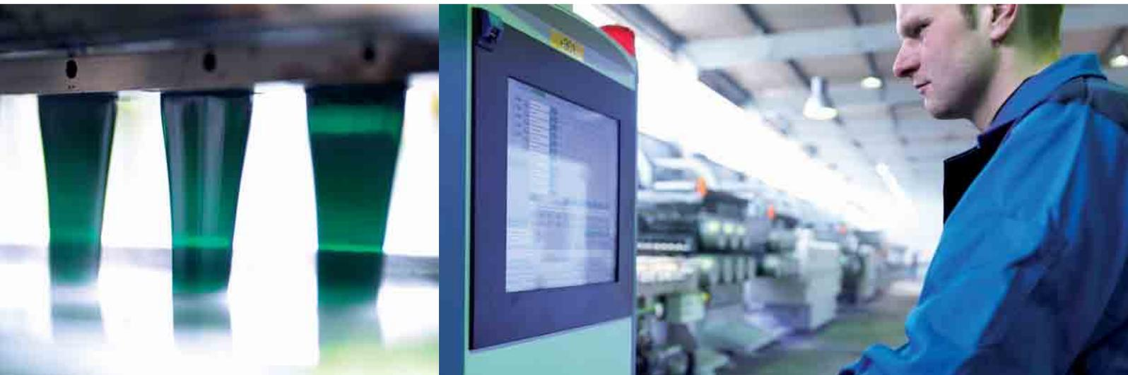
Bei der hochmodernen Fertigung von PET-Band wird hundertprozentiges Polyester-Recyclingmaterial in einem Extrusionsprozess zu hochwertigen Umreifungsbändern verarbeitet. Auch Stahlband für härteste Anwendungen stellen wir selbst her: Im familieneigenen Unternehmen steht dafür modernste Fertigungstechnik bereit.
