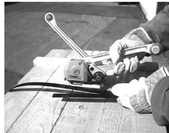
Saisir alors les 2 brins de feuillard de la main gauche de façon à ce qu'ils se Recouvrent parfaitement. Saisir de la main droite la poignée **520** et le levier **96**. Refermer la main en serrant. Introduire les deux brins dans l'appareil jusqu'en butée à l'intérieur du carter. Le brin inférieur doit dépasser de quelque peu de l'appareil. Relâcher la pression de la poignée **520** et du levier **96**.
