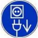
**Achtung!** Vor sämtlichen Wartungsarbeiten ist das Umreifungsaggregat vom Stromnetz zu trennen.
