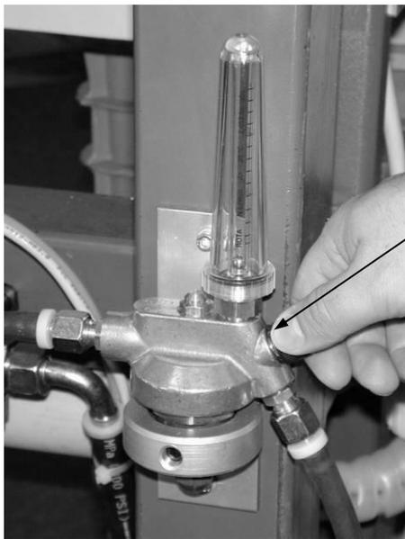
Stellen Sie die Gasmenge an der Regulierschraube des Druckminderers ein.
