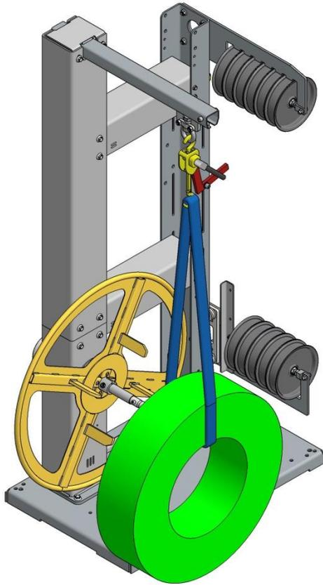
Die Bandrolle mit einem Schlupf am Hacken des Hebelzugs befestigen.
