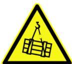
**Achtung!** Beim Heben und Absetzen nicht unter der Last stehen. Umstehende aus dem Gefahrenbereich weisen. Mindest-Tragkraft 500 kg.
