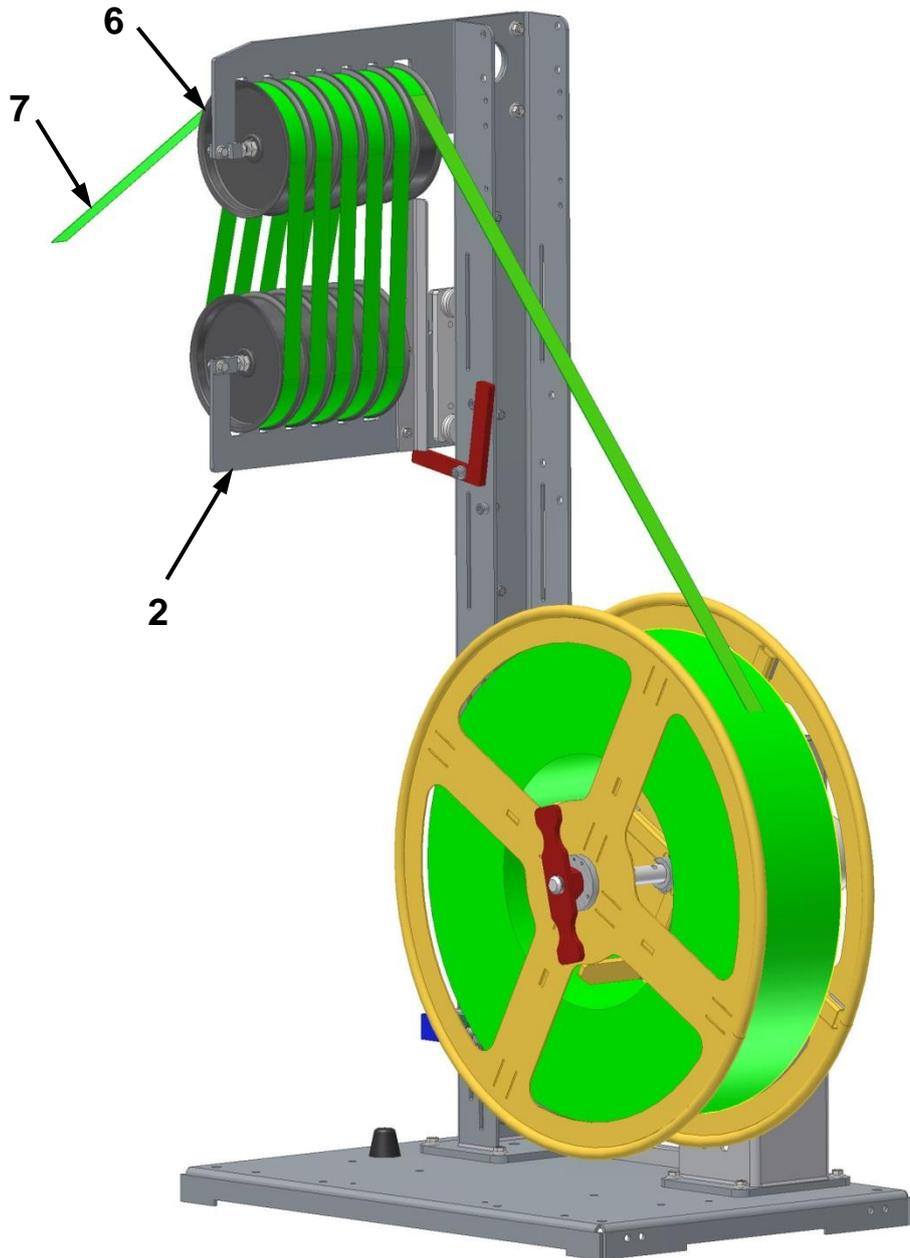
Dieser Vorgang ist beendet, wenn der **Rollenschlitten (2)** unten und die Bremse des Bandspeichersystems betätigt ist.
