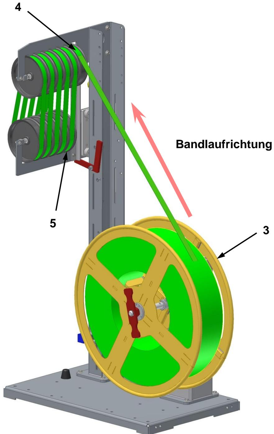
Das von der letzten, **oberen Rolle (6)** abgehende **Bandende (7)** festhalten. Den **Schlitten (2)** nach oben schieben, der Hebel fällt automatisch in seine Ausgangsposition. Danach den **Schlitten (2)** langsam nach unten ablassen.
